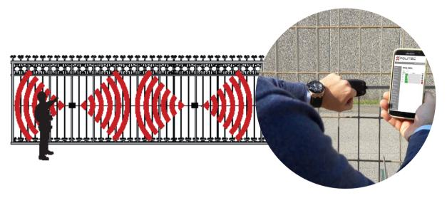
Gapid SR è un sistema intelligente composto da una serie di sensori accelerometrici MEMS con tecnologia avanzata. Gapid è un sensore antiscavalcamento, anti-taglio e antisfondamento per protezioni perimetrali.
