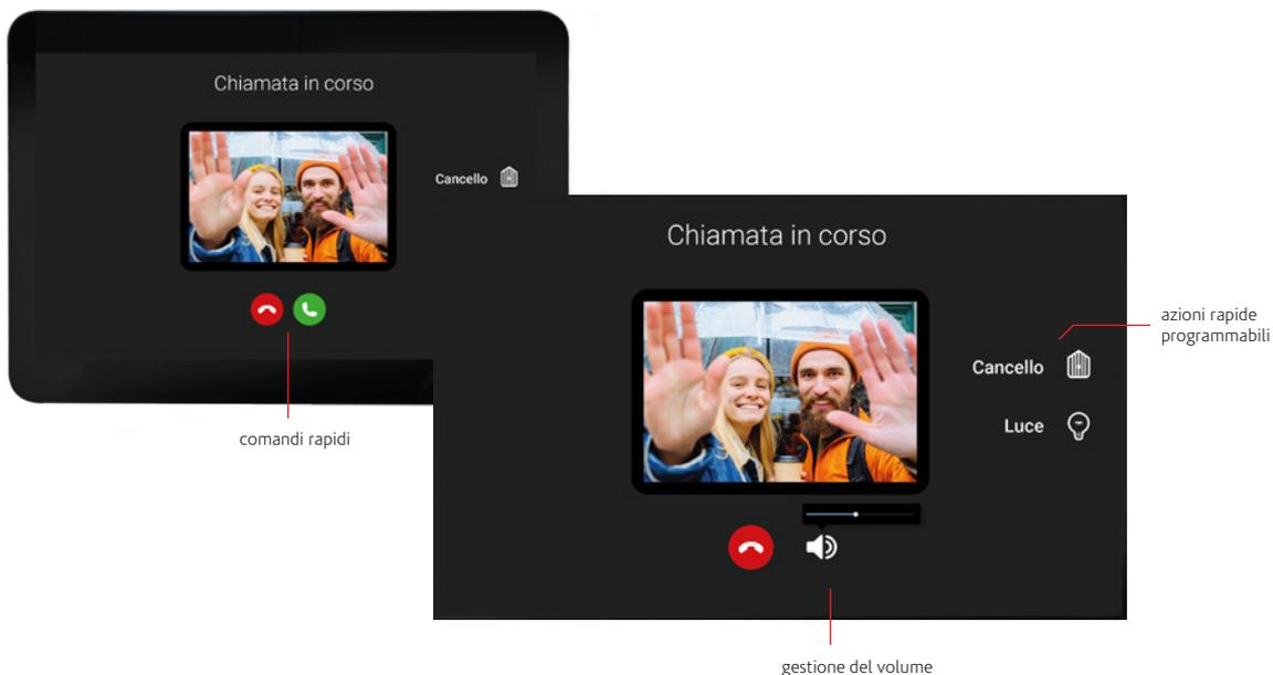
La piattaforma IoT lares 4.0 si integra con il **mondo della videocitofonia SIP**, implementando nella propria tastiera touch-screen ergo-T pro un client SIP per la comunicazione audio-video con un posto esterno compatibile SIP di terze parti la tastiera funge così da postazione interna.
