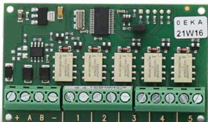
**auxi relè** dispone di 5 uscite relè da 1A che possono essere utilizzate nelle centrali della serie **lares 4.0** per la gestione di qualsiasi tipo di carico.
