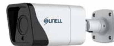
Telecamera bullet analogica ibrida FULL HD 1080p, sensore 1/2,9" Sony CMOS, ottica 3,6 mm, dWDR, DNR 2D, 24 led IR per una illuminazione fino a 20 m, risoluzione massima 1920x1080 / 25 fps, OSD controllabile tramite joystick, IP66, alimentazione 12 Vcc.
