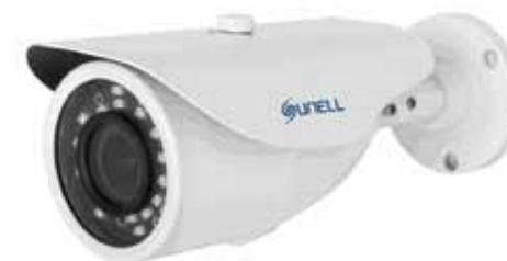
Telecamera bullet H.265 / H.264, sensore 1/3" Progressive Scan CMOS, ottica 3,6 mm, WDR > 120 dB, DNR 2D / 3D, 24 led IR per una illuminazione fino a 35 m, risoluzione massima 2592x1520 / 30 fps, analisi video on board, menù OSD in lingua italiana, compatibile ONVIF, porta RJ-45, IP66, alimentazione 12 Vcc / POE.
