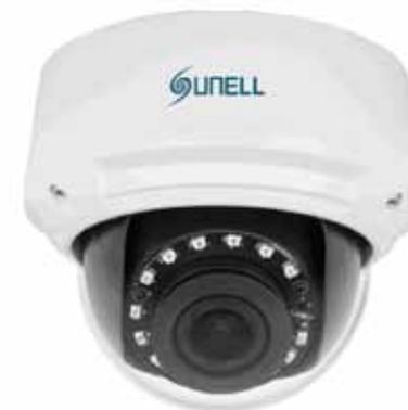
Telecamera dome analogica ibrida FULL HD 5 Mpixel / 4 Mpixel, sensore 1/2,5" CMOS, ottica motorizzata autofocus 2,7 ~ 13,5 mm, dWDR, DNR auto/manuale, 15 led IR per una illuminazione fino a 30 m, risoluzione massima 2560x1920 / 20 fps, OSD controllabile tramite joystick, IP66, alimentazione 12 Vcc.
