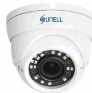
Telecamera dome analogica ibrida FULL HD 4 Mpixel, sensore 1/3" CMOS, ottica 2,8 ~ 12 mm, dWDR, DNR auto/manuale, 24 led IR per una illuminazione fino a 35 m, risoluzione massima 2560x1440 / 25 fps, OSD controllabile tramite joystick, IP66, alimentazione 12 Vcc.
