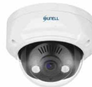
Telecamera mini dome H.265 / H.264, sensore 1/2,7" Progressive Scan CMOS, ottica 2,8 mm, WDR > 120 dB, DNR 2D / 3D, 2 led IR per una illuminazione fino a 20 m, risoluzione massima 1920x1080 / 30 fps, analisi video on board, menù OSD in lingua italiana, compatibile ONVIF, porta RJ-45, IP66, alimentazione 12 Vcc / POE.
