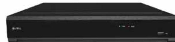
Videoregistratore digitale 3 Mpixel 5 in 1, 16 ingressi BNC (AHD fino a 3 Mpixel /TVI/CVI fino a 2 Mpixel, CVBS 960H) + 8 fusti video IP. 4 ingressi audio / 1 uscita, funzione P2P e DDNS proprietario, uscite video HDMI 4K e VGA, gestione di 1 HDD da massimo 6 TB, controllo Coaxitron via cavo coassiale del menù / zoom / PTZ delle telecamere abilitate, porta RS485, 2 porte USB, alimentazione 12 Vcc, alimentatore incluso.
