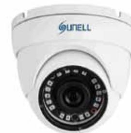
Telecamera dome analogica ibrida FULL HD 5 Mpixel / 4 Mpixel, sensore 1/2,5" CMOS, ottica 3,6 mm, dWDR, DNR auto/manuale, 18 led IR per una illuminazione fino a 20 m, risoluzione massima 2560x1920 / 20 fps, OSD controllabile tramite joystick, IP66, alimentazione 12 Vcc.
