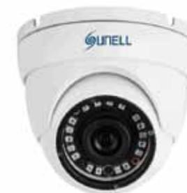
Telecamera dome analogica ibrida FULL HD 4 Mpixel, sensore 1/3" CMOS, ottica 3,6 mm, dWDR, DNR auto/manuale, 18 led IR per una illuminazione fino a 20 m, risoluzione massima 2560x1440 / 25 fps, OSD controllabile tramite joystick, IP66, alimentazione 12 Vcc.
