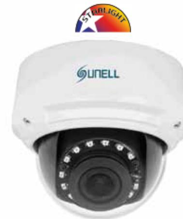
Telecamera dome Starlight 2 Mpixel H.265 / H.264, sensore 1/2" Progressive Scan CMOS, ottica motorizzata autofocus 3,6 ~ 11 mm, True WDR > 120 dB, DNR 2D / 3D, 15 led IR per una illuminazione fino a 30 m, risoluzione 1920x1080 / 60 fps, analisi video on board, menù OSD in lingua italiana, compatibile ONVIF, porta RJ-45, 1 ingresso / 1 uscita audio, 1 ingresso / 1 uscita allarme, RS485, uscita BNC, pulsante reset, slot per micro SD/SDHC/SDXC 128 GB, IP66, IK10, alimentazione 12 Vcc / POE.
