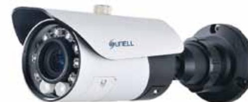
Telecamera bullet IP H.265, 2 Mpixel, sensore 1/2,8" Progressive Scan CMOS, ottica motorizzata autofocus 2,7~12 mm, WDR> 120 dB, DNR 2D / 3D, 10 led IR per una illuminazione fino a 30 m, risoluzione 1920x1080 / 60 fps, analisi video on board, menù OSD in lingua italiana, compatibile ONVIF, porta RJ-45, 1 ingresso / 1 uscita audio, uscita BNC, pulsante reset, slot per micro SD/SDHC/SDXC 128 GB, IP67, alimentazione 12 Vcc / POE.
