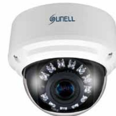
Telecamera dome H.265 / H.264, sensore 1/3" Progressive Scan CMOS, ottica motorizzata autofocus 2,8 ~ 12 mm, WDR > 120 dB, DNR 2D / 3D, 12 led IR per una illuminazione fino a 30 m, risoluzione massima 2592x1520 / 30 fps, analisi video on board, menù OSD in lingua italiana, compatibile ONVIF, porta RJ-45, IP66, IK10, alimentazione 12 Vcc / POE.
