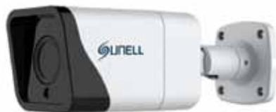
Telecamera bullet analogica starlight 1080p, sensore 1/2,8" Sony CMOS, ottica 3,6 mm, dWDR > 120 dB, DNR 3D, 24 led IR per una illuminazione fino a 30 m, risoluzione massima 1920x1080 / 25 fps, OSD controllabile tramite joystick, IP66, alimentazione 12 Vcc.
