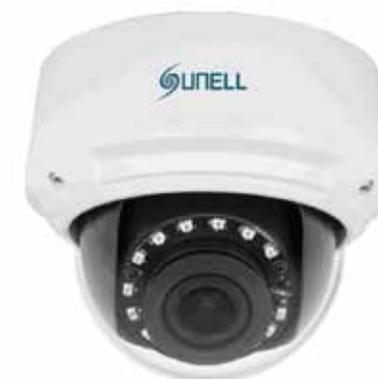
Telecamera dome ibrida 1080p FULL HD, sensore 1/3" CMOS, ottica motorizzata autofocus 2,8 ~ 12 mm, dWDR, DNR auto/manuale, 15 led per una illuminazione fino a 30 m, risoluzione massima 2560x1440 / 25 fps, OSD controllabile tramite joystick, IP66, alimentazione 12 Vcc.
