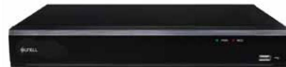
Videoregistratore digitale 4 Mpixel 5 in 1, 4 ingressi BNC (AHD fino a 4 Mpixel /TVI/CVI fino a 2 Mpixel, CVBS 960H ) + 2 fussi video IP. 4 ingressi audio / 1 uscita, 4 ingressi allarme / 1 uscita, funzione P2P e DDNS proprietario, uscite video HDMI e VGA, gestione di 1 HDD da massimo 6 TB, controllo Coaxitron via cavo coassiale del menù / zoom / PTZ delle telecamere abilitate, porta RS485, 2 porte USB, alimentazione 12 Vcc, alimentatore incluso.
