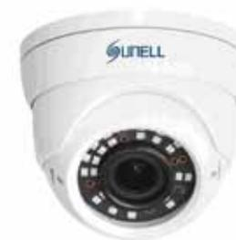
Telecamera dome analogica starlight 1080p, sensore 1/2,8" Sony CMOS, ottica varifocale 2,8 ~12 mm, WDR> 120 dB, DNR 3D, 24 led per una illuminazione fino a 35 m, risoluzione massima 1920x1080 / 25 fps, OSD controllabile tramite joystick, IP66, alimentazione 12 Vcc.
