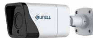
Telecamera bullet analogica ibrida FULL HD 5 Mpixel / 4 Mpixel, sensore 1/2,5" CMOS, ottica 3,6 mm, dWDR, DNR auto/manuale, 24 led IR per una illuminazione fino a 20 m, risoluzione massima 2560x1920 / 20 fps, OSD controllabile tramite joystick, IP66, alimentazione 12 Vcc.
