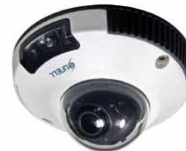
Telecamera dome antivandalo IP H.265, 4 Mpixel, sensore 1/3" Progressive Scan CMOS, ottica fissa 2,8 mm, WDR> 100 dB, DNR 2D / 3D, 1 led IR per una illuminazione fino a 10 m, risoluzione massima 2592x1520 / 4 Mpixel, menù OSD in lingua italiana, compatibile compatibile ONVIF, porta RJ-45, 1 ingresso / 1 uscita audio, 1 uscita BNC, pulsante reset, slot per micro SD/SDHC 128 GB, IP65, IK8, alimentazione 12 Vcc / POE.
