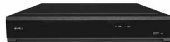
NVR 8 canali H.265 / H.264, risoluzione massima gestita 8 Mpixel (4K), 1 porta Ethernet 10/100/1000 Mbps, Live e Playback contemporaneo di 4 telecamere fino a 8 Mpixel, DDNS proprietario e P2P, uscite video VGA ed HDMI, risoluzione uscita video HDMI fino a 4K, banda massima di registrazione 100 Mbps, gestione di 1 HDD da massimo 6 TB, 8 ingressi / 1 uscita allarme, compatibile ONVIF S-Profile 2.6, compatibile iPhone, iPad, Android, alimentazione 12 Vcc tramite alimentatore incluso,
