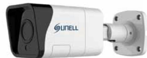
Telecamera bullet analogica ibrida FULL HD 5 Mpixel / 4 Mpixel, sensore 1/2,5" CMOS, ottica motorizzata autofocus 2,7 ~ 13,5 mm, dWDR, DNR auto/manuale, 30 led IR per una illuminazione fino a 40 m, risoluzione massima 2560x1920 / 20 fps, OSD controllabile tramite joystick, IP66, alimentazione 12 Vcc.
