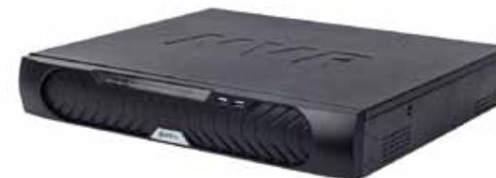
NVR 32 canali, risoluzioni 6M / 5M / 4M / 3M / 1080p / 720p, 2 porte RJ-45 standard 10/100/1000Mbps, gestione di 4 HDD da max 4 TB per un max di 16 Tb, server DHCP per programmazione diretta telecamere Sunell, compatibile ONVIF, uscite video HDMI e VGA, banda massima in ingresso 192 Mbps, 2 porte USB, 1 ingresso / 1 uscita allarme, 1 ingresso / 1 uscita audio, alimentazione 230 Vca - 200 W max.
