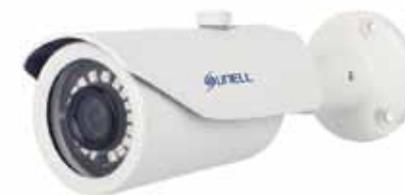
Telecamera bullet 4 in 1, AHD / TVI / CVI / CVBS, sensore 1/2,7" Progressive Scan CMOS, ottica 3,6 mm, dWDR, DNR 2D, 18 led IR per una illuminazione fino a 20 m, risoluzione massima 1920x1080 / 25 fps, OSD controllabile tramite joystick, IP66, alimentazione 12 Vcc.
