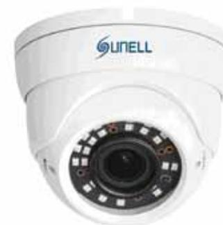
Telecamera 3Axis dome FULL HD 5 Mpixel / 4 Mpixel, sensore 1/2,5" CMOS, ottica 3,3 ~ 13,5 mm, dWDR, DNR auto/manuale, 24 led IR per una illuminazione fino a 35 m, risoluzione massima 2560x1920 / 20 fps, OSD controllabile tramite joystick, IP66, alimentazione 12 Vcc / POE.
