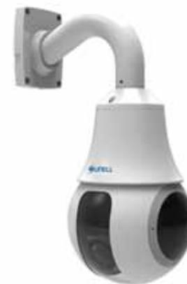
Telecamera mini PTZ Starvis 3 Mpixel H.265 / H.264, sensore 1/2,8" Progressive Scan CMOS, ottica modulo Sunell 12X 4,7 ~ 56,4 mm, zoom digitale 16X, dWDR, DNR 2D / 3D, 6 led IR per una illuminazione fino a 100 m, risoluzione 2048x1536 / 30 fps, analisi video on board, menù OSD in lingua italiana, compatibile ONVIF, porta RJ-45, 1 ingresso / 1 uscita audio, 2 ingressi / 1 uscita allarme, pulsante reset, slot per micro SD/SDHC/SDXC 64 GB, IP66, TVS4000V, IK10, alimentazione 12 Vcc / POE.
