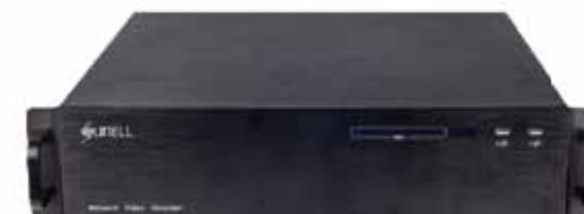
NVR 32 canali H.265 / H.264, risoluzioni supportate 8MP / 6MP / 5MP / 4MP / 3MP / 1080P / 720P, 2 porte di rete RJ-45 10/100/1000 Mbps, gestione di massimo 2 HDD da 6 TB/cad, compatibile ONVIF, uscite video HDMI e VGA simultanee con risoluzione fino a 4K, banda massima in ingresso 256 Mbps, 16 ingressi / 4 uscite allarme, 1 ingresso / 1 uscita audio, 2 porte USB 2.0 ed 1 porta USB 3.0, alimentazione 12 Vcc tramite alimentatore esterno a corredo.
