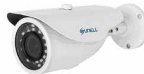
Telecamera bullet H.265 / H.264, sensore 1/3" Progressive Scan CMOS, ottica 2,7 ~ 13,5 mm, WDR > 120 dB, DNR 2D / 3D, 24 led IR per una illuminazione fino a 35 m, risoluzione massima 2592x1520 / 30 fps, analisi video on board, menù OSD in lingua italiana, compatibile ONVIF, porta RJ-45, IP66, alimentazione 12 Vcc / POE.
