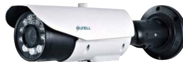
Telecamera Bullet IP risoluzione 2 Mpixel con lettura targhe ANPR. ottica motorizzata autofocus 7 ~ 22 mm, risoluzione 1920x1080 / 30fps, sensore da 1/2,9" Progressive Scan CMOS, Smart IR, 14 Led IR Piranha + 3 Led Array per una illuminazione fino a 40 m, 2D/3D-DNR, dWDR > 100 dB, ICR, menu OSD in lingua Italiana, slot per memorie SD/SDHC da max 64Gb, analisi video on-board, IP66, alimentazione 12 VCC / POE 8 W.
