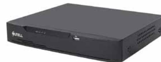
NVR 8 canali POE H.265 / H.264, risoluzione massima gestita 8 Mpixel, gestione di 1 HDD da massimo 8 TB, 1 porta RJ-45 10/100 Mbps, 8 porte POE 100 Mbps, 1 uscita HDMI / 1 uscita VGA, 2 porte USB, 1 ingresso / 1 uscita audio, 8 ingressi / 1 uscita allarme, alimentazione 48 Vcc.
