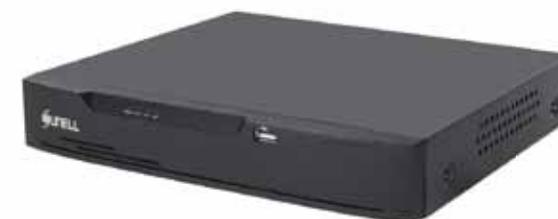
Videoregistratore digitale 4 in 1, 4 ingressi BNC (AHD / TVI / CVI / CVBS) / 4 fusti video IP 1080p, 4 ingressi / 1 uscita audio, 1 uscita VGA / 1 uscita HDMI, gestione di 1 HDD da massimo 6 Tb, controllo Coaxitron via cavo coassiale del menù / zoom / PTZ delle telecamere abilitate, porta RS485, 2 porte USB, alimentazione 12 Vcc, alimentatore incluso.
