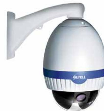
Telecamera speed dome Starvis 2 Mpixel H.265 / H.264, sensore 1/2,8" Progressive Scan CMOS, ottica modulo Sunell 22X 4,7 ~ 103mm, zoom digitale 16X, dWDR, DNR 2D / 3D, risoluzione 1920x1080 / 30 fps, analisi video on board, compatibile ONVIF, porta RJ-45, 1 ingresso / 1 uscita audio, 2 ingressi / 1 uscita allarme, RS485, uscita BNC, pulsante reset, slot per micro SD/SDHC 128 GB, IP66, TVS6000V, alimentazione 24 Vcc / POE.
