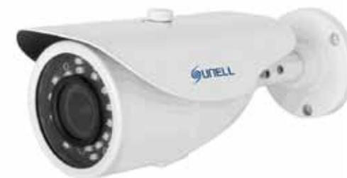
Telecamera bullet H.265 / H.264, sensore 1/2,7" Progressive Scan CMOS, ottica 2,7 ~ 13,5 mm, WDR > 120 dB, DNR 2D / 3D, 24 led IR per una illuminazione fino a 35 m, risoluzione massima 1920x1080 / 30 fps, analisi video on board, menù OSD in lingua italiana, compatibile ONVIF, porta RJ-45, IP66, alimentazione 12 Vcc / POE.
