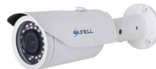
Telecamera bullet analogica ibrida FULL HD 1080p, sensore 1/2,9" Sony CMOS, ottica varifocale 2,8 ~ 12 mm, dWDR, DNR 2D, 30 led IR per una illuminazione fino a 40 m, risoluzione massima 1920x1080 / 25 fps, OSD controllabile tramite joystick, IP66, alimentazione 12 Vcc.
