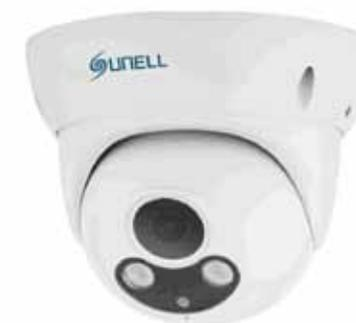
Telecamera mini dome antivandalo IP H.265 / H.264, 4 Mpixel, sensore 1/3" Progressive Scan CMOS, ottica 2,8 mm, WDR > 120 dB, DNR 2D / 3D, 2 led IR per una illuminazione fino a 20 m, risoluzione 2592x1520 / 30 fps, analisi video on board, menù OSD in lingua italiana, compatibile ONVIF, porta RJ-45, microfono, 1 ingresso / 1 uscita audio, 1 ingresso / 1 uscita allarme (opzionale), pulsante reset, IP67, alimentazione 12 Vcc / POE.
