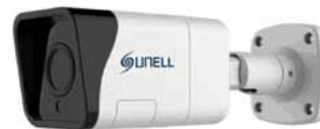
Telecamera bullet analogica ibrida FULL HD 5 Mpixel / 4 Mpixel, sensore 1/3" CMOS, ottica motorizzata autofocus 2,8 ~ 12 mm, dWDR, DNR auto/manuale, 30 led IR per una illuminazione fino a 40 m, risoluzione massima 2560x1440 / 25 fps, OSD controllabile tramite joystick, IP66, alimentazione 12 Vcc.
