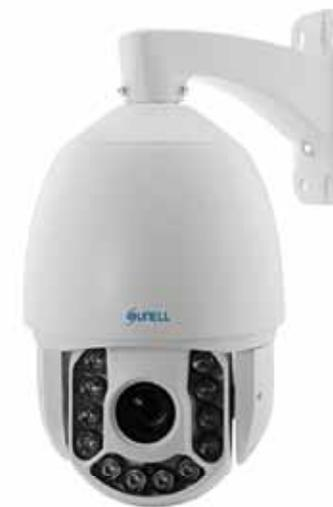
Telecamera speed dome AHD, risoluzione 1080p FULL HD, sensore 1/2,9" Sony CMOS, zoom ottico 20X 4,7 ~ 94 mm, velocità di rotazione 220°/sec, dWDR, DNR 2D / 3D, 12 led IR per una illuminazione fino a 150 m, 128 preset, 4 tour, 4 pattern, 4 scan, IP66, TVS4000V, alimentazione 24 Vca, alimentatore e staffa da parete inclusi.
