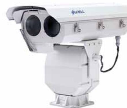
Telecamera bullet termica IP, risoluzione 396x264, sensore Uncooled IRFPA, sensibilità termica 50 mK, lunghezza d'onda rilevata 8÷14 µm, ottica da 100 mm, possibili visualizzazioni: bianco/nero, effetto incandescente, effetto arcobaleno ed effetto ruggine. IP66, alimentazione 24 Vca.
