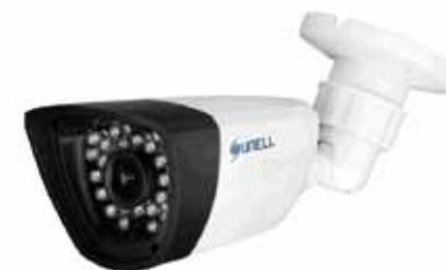
Telecamera bullet AHD, sensore 1/4" CMOS, ottica 3,6 mm, dWDR, DNR 2D, 24 led IR per una illuminazione fino a 20 m, risoluzione massima 1920x1080 / 25 fps, OSD controllabile tramite joystick, IP66, case plastico, alimentazione 12 Vcc.
