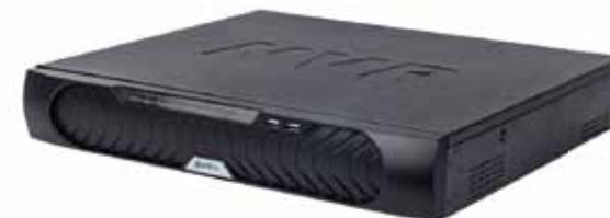
NVR 32 canali H.265 / H.264, risoluzioni supportate 8MP / 6MP / 5MP / 4MP / 3MP / 1080P / 720P, 16 Porte POE 10/100 per telecamere, 1 porta di rete RJ-45 10/100/1000 Mbps, gestione di massimo 4 HDD da 6 TB/cad, compatibile ONVIF, uscite video HDMI e VGA simultanee con risoluzione fino a 4K, banda massima in ingresso 256 Mbps, 2 ingressi / 2 uscite di allarme, 1 ingresso / 1 uscita audio, 2 porte USB 2.0 ed 1 porta USB 3.0, alimentazione 230 Vca.
