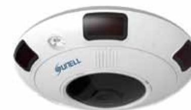
Telecamera fish-eye Starvis 12 Mpixel H.265 / H.264, sensore 1/1,7" Progressive Scan CMOS, ottica 1,8 mm, dWDR, DNR 2D / 3D, 6 led IR per una illuminazione fino a 10 m, risoluzione massima 4000x3000 / 20 fps, analisi video on board, menù OSD in lingua italiana, compatibile ONVIF, porta RJ-45, microfono, 1 ingresso / 1 uscita audio, 1 ingresso / 1 uscita allarme, pulsante di reset, slot micro SD/SDHC/SDXC 128 GB, IP67, alimentazione 12 Vcc / POE.
