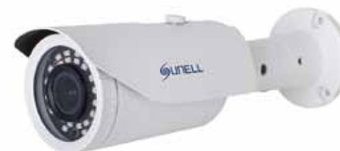
Telecamera bullet 4 in 1, AHD / TVI / CVI / CVBS, sensore 1/2,7" Progressive Scan CMOS, ottica motorizzata autofocus 2,8 ~ 12 mm, dWDR, DNR 2D, 30 led IR per una illuminazione fino a 40 m, risoluzione massima 1920x1080 / 25 fps, OSD controllabile tramite joystick, IP66, alimentazione 12 Vcc.
