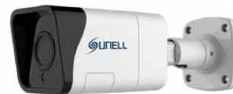
Telecamera bullet 8 Mpixel, sensore 1/2,5" Progressive Scan CMOS, ottica motorizzata autofocus 3,3 ~ 12 mm, WDR > 120 dB, DNR 2D / 3D, 30 led IR per una illuminazione fino a 50 m, risoluzione massima 3840x2160, analisi video on board, menù OSD in lingua italiana, compatibile ONVIF, IP67, alimentazione 12 Vcc / POE.
