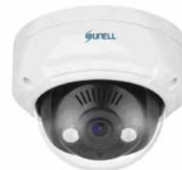
Telecamera mini dome H.265 / H.264, sensore 1/3" Progressive Scan CMOS, ottica 2,8 mm, WDR > 120dB, DNR 2D / 3D, 2 led IR per una illuminazione fino a 20 m, risoluzione massima 2592x1520 / 30 fps, analisi video on board, menù OSD in lingua italiana, compatibile ONVIF, porta RJ-45, IP66, alimentazione 12 Vcc / POE.
