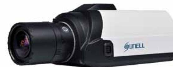
Telecamera box Starlight 2 Mpixel H.265 / H.264, sensore 1/1,9" Progressive Scan CMOS, dWDR, DNR 2D / 3D, risoluzione 1920x1080 / 60 fps, analisi video on board, menù OSD in lingua italiana, compatibile ONVIF, porta RJ-45, microfono, 1 ingresso / 1 uscita audio, 1 ingresso / 1 uscita allarme, RS485, uscita BNC, pulsante reset, slot per micro SD/SDHC/SDXC 128 GB, alimentazione 12 Vcc / POE. Ottica non compresa.
