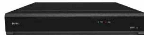
NVR 4 canali H.265 / H.264, risoluzione massima gestita 8 Mpixel (4K), 1 porta Ethernet 10/100/1000 Mbps, Live e Playback contemporaneo di 4 telecamere fino a 8 Mpixel, DDNS proprietario e P2P, uscite video VGA ed HDMI, risoluzione uscita video HDMI fino a 4K, banda massima di registrazione 50 Mbps, gestione di 1 HDD da massimo 6 TB, 4 ingressi / 1 uscita allarme, compatibile ONVIF S-Profile 2.6, compatibile iPhone, iPad, Android, alimentazione 12 Vcc tramite alimentatore incluso.
