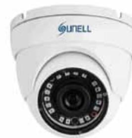
Telecamera dome analogica ibrida FULL HD 1080p, sensore 1/2,9" Sony CMOS, ottica fissa 3,6 mm, dWDR, DNR2D, 18 led per una illuminazione fino a 20 m, risoluzione massima 1920x1080 / 25 fps, OSD controllabile tramite joystick, IP66, alimentazione 12 Vcc.
