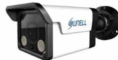
Telecamera mini bullet IP H.265 / H.264, 4 Mpixel, sensore 1/3" Progressive Scan CMOS, ottica motorizzata autofocus 2,8 ~ 8 mm, WDR > 120 dB, DNR 2D / 3D, 2 led IR Array proporzionali per una illuminazione fino a 30 m, risoluzione 2592x1520 / 30 fps, menù OSD in lingua italiana, compatibile ONVIF, IP67, alimentazione 12 Vcc / POE.
