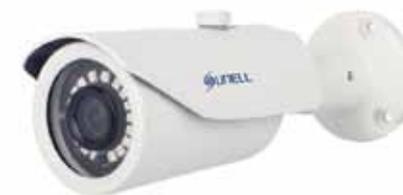
Telecamera bullet analogica ibrida FULL HD 1080p, sensore 1/2,9" Sony CMOS, ottica fissa 3,6 mm, dWDR, DNR 2D, 18 led IR per una illuminazione fino a 20 m, risoluzione massima 1920x1080 / 25 fps, OSD controllabile tramite joystick, IP66, alimentazione 12 Vcc.
