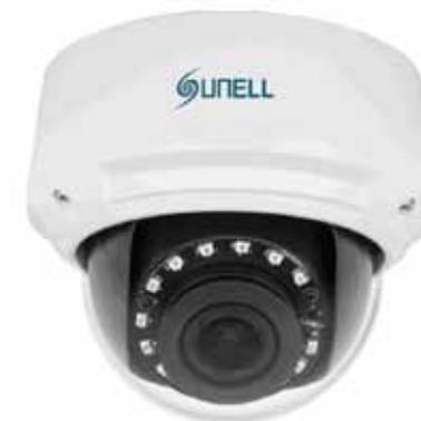
Telecamera dome ibrida 1080p FULL HD, sensore 1/2,9" Sony CMOS, ottica motorizzata autofocus 2,8 ~ 12 mm, dWDR, DNR 2D, 15 led per una illuminazione fino a 30 m, risoluzione massima 1920x1080 / 25 fps, OSD controllabile tramite joystick, IP66, IK10, alimentazione 12 Vcc.
